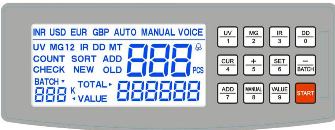
**“UV” dugme:** pritisnite ovo dugme da uključite / isključite UV detekciju.
